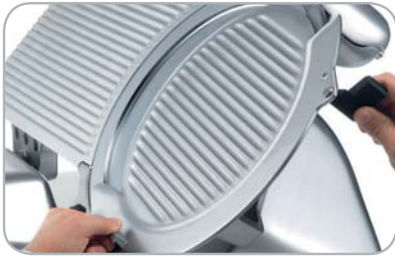
Pratico smontaggio del coprilama Easily removable blade cover
