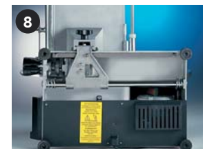
7. Meccanismo sgancio piatto affettatrice Carriage interlock on open gauge 8. Protezione inferiore Bottom shield
