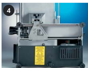
1. Paramano piatto in plexiglass Plexiglass hand guard 2. Elsa su manopola pressamerce Hilt on product pusher handle 3. Microinterruttore su paralama Microswitch on blade cover 4. Protezione inferiore Bottom shield
