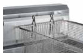
Posizione di sgocciolo Position of drip
