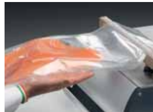
Utilizzo di buste gofrate per il vuoto fuori campana Embossed bags can be used to seal bigger products holding them outside the lid
