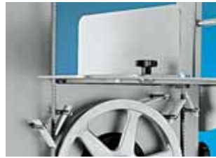
Raschiatori lama in materiale plastico alimentare ad innesto rapido. Flangia in materiale plastico alimentare nero a tenuta stagna per protezione motore
