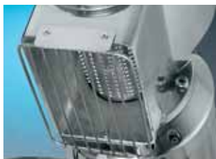
Griglia di protezione rullo Protection grate drum
